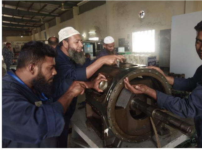
চিত্রঃ বিসিজিএস কামরুজ্জামান এর এসি প্ল্যান্টের ৪ নং কম্প্রেসরের ওভারহলিং কাজের চিত্র।
