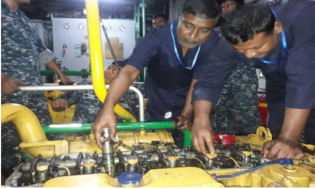
চিত্রঃ বানোজা দুর্গম এর ডিজি নং ৩ এর ৫টি ইঞ্জেক্টর "ও" রিং এবং ১টি ইঞ্জেক্টর পরিবর্তন করার স্থির চিত্র।
