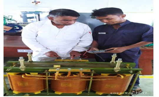
চিত্র: বিএন ডকইয়ার্ড মোংলা (এডহক) কর্তৃক বানৌজা আবু উবাইদাহ্ এর আইসোলেশন ট্রান্সফরমার চেক ও লোড টেস্ট কার্য
